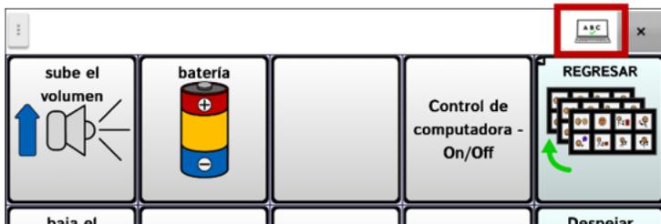
Al tocar el botón de nuevo, el símbolo en la BVH desaparecerá automáticamente, y aparecerá un mensaje cerca de la parte inferior de la pantalla indicando que está desconectado de la computadora.
