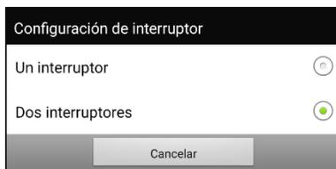
Si seleccionó **Un interruptor** en la ventana de Configuración de interruptor, se activará el Interruptor 1 y el Interruptor 2 aparecerá oscurecido. Si seleccionó **Dos interruptores**, se activará tanto el Interruptor 1 como el Interruptor 2.
