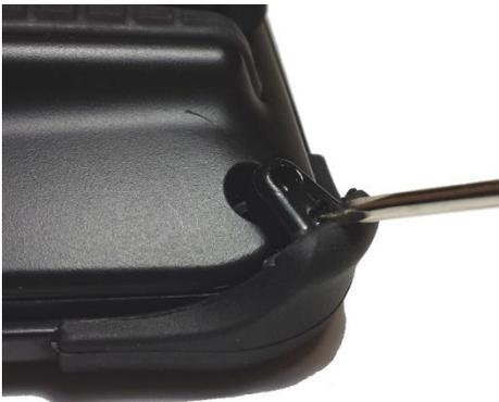
2. Con cuidado, hale la lengüeta hacia afuera del equipo, hasta que pueda deslizar la esquina del marco y desengancharlo del equipo.
