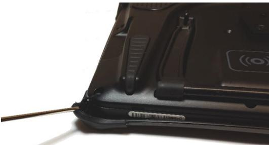
4. Hale la lengüeta hacia afuera del equipo hasta que pueda deslizar la esquina del marco.
