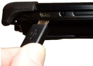
2. Conecte el cable al puerto de carga que está en el lado del equipo, al lado del botón de encendido. También puede usar el cable cargador incluido con la almohadilla de carga para cargar el equipo directamente.
