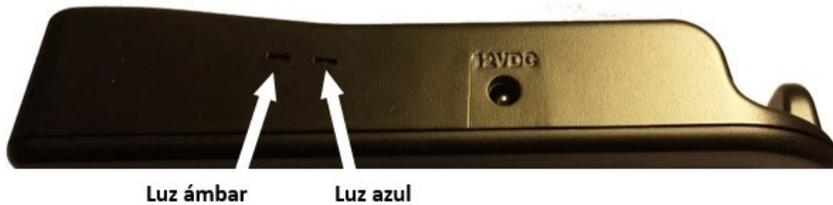
La luz color ámbar indicadora de carga del ChatFusion estará iluminada. Cuando la batería esté completamente cargada, se iluminará la luz azul.
