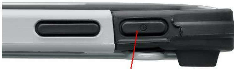
Interruptor para prender y apagar el equipo.
