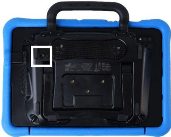
Le bouton de puissance pour l'amplificateur (étiquetés «I/O » sur certains appareils) est encastré. Utilisez la pointe d'un stylo lorsque vous devez appuyer sur le bouton. N'utilisez pas un objet avec une pointe pointue, comme une épingle; cela pourrait endommager le bouton.
