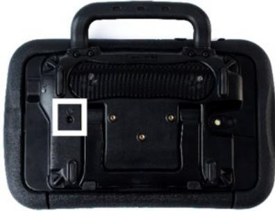
Los botones para encender y apagar el amplificador (identificado como "I/O") están ahuecados hacia adentro. Use la punta de un bolígrafo cuando necesite tocar el botón. No use un objeto con una punta afilada, como un alfiler, ya que puede dañar el botón.
