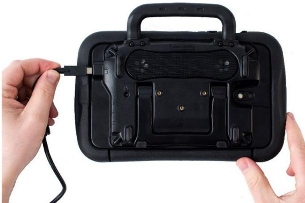
4. La luz de carga al lado del puerto de carga debe estar parpadeando mientras las baterías cargan y permanecerá encendida cuando la batería esté completamente cargada.
